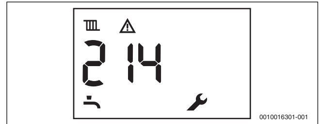
Fig. 69 Exemplu: defecțiune care nu determină blocare
