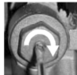
Fig. 30 Reglarea supapei de suprapresiune
