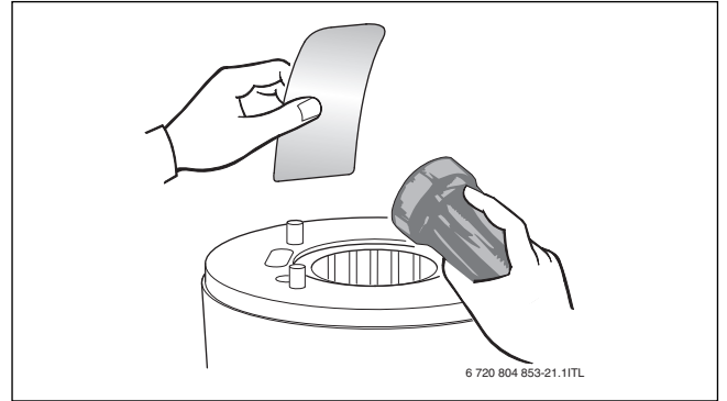
Fig. 45 Verificarea schimbatorului de căldură în privința reziduurilor
